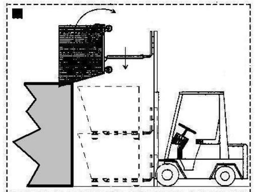
CALARE LE FORCHE. QUANDO LA PARETE OBLIQUA DEL CONTENITORE APPOGGIA SUL BORDO DEL CONTAINER IL CONTENITORE STESSO SI RADDRIZZA. UNA VOLTA CALATOLO A TERRA TENENDO IL BRANDEGGIO VERSO L'OPERATORE AGGANCIARE LA LEVA DI SICUREZZA.
